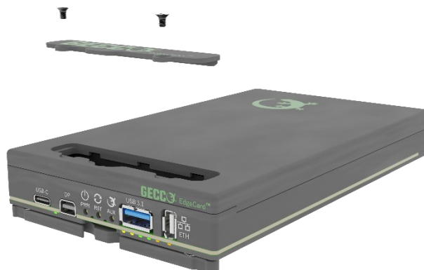
Figura 2. Acceso a la batería RTC en la EdgeCard
