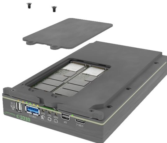
Figura 1. Acceso a las Ranuras de Expansión M.2
